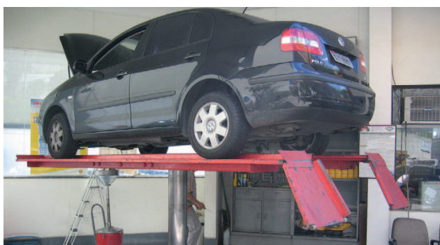
Elevador hidráulico de automóveis (prensa hidráulica).
