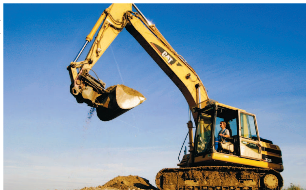
Multiplicadores hidráulicos de forças em retroscavadeiras.
